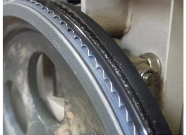
3-3 ブレードガード: 左右のブレードガイドは、ブレードのアサリの部分を外して左右からサポートします。名刺1枚ぐらいの隙間に調整します。後ろのガードとも名刺1枚ぐらいの隙間に調整します。
