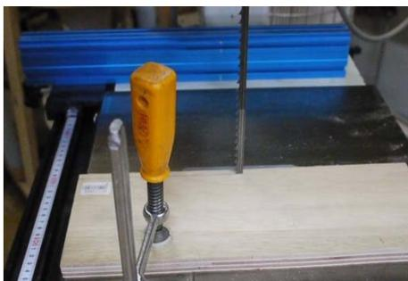
クランプした板の横にフェンスを持ってきて平行を確認します。平行になっていない場合がほとんどですので、フェンスの元のネジを緩めてフェンスの角度を板と平行になるよう調整します。
